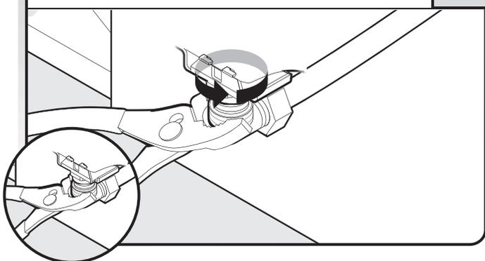
S'assurer que la rondelle de caoutchouc est correctement installée dans le raccord. Enfiler le raccord de 3/4" vers le haut jusqu'à la valve et serrer à la main afin d'éviter de fausser le filetage. Serrer à la main jusqu'à ce que le raccord soit serré. À l'aide d'une pince, vérifier l'étanchéité du raccord. 1/4 à 1/2 tour supplémentaire peut s'avérer nécessaire pour créer l'étanchéité du joint de caoutchouc.
